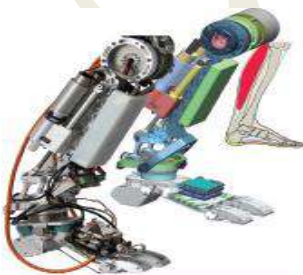
ساق الرجل الآلي مدعومة بالعضلات الهوائية
