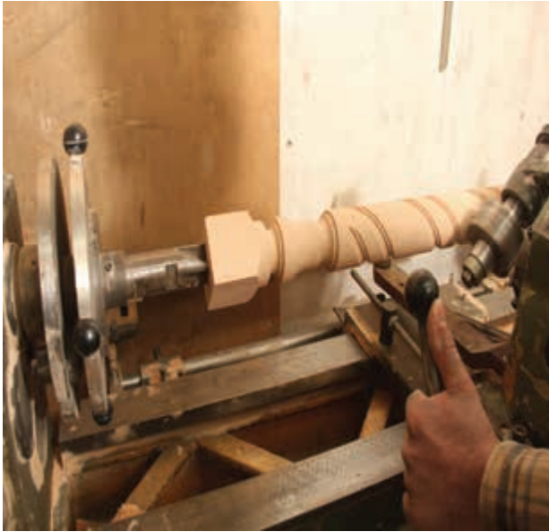
الشكل (٨-١): طريقة عمل الخراطة اللولبية.
