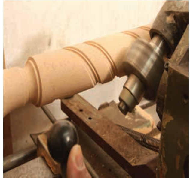
الشكل (٨-١): طريقة عمل الخراطة اللولبية.
