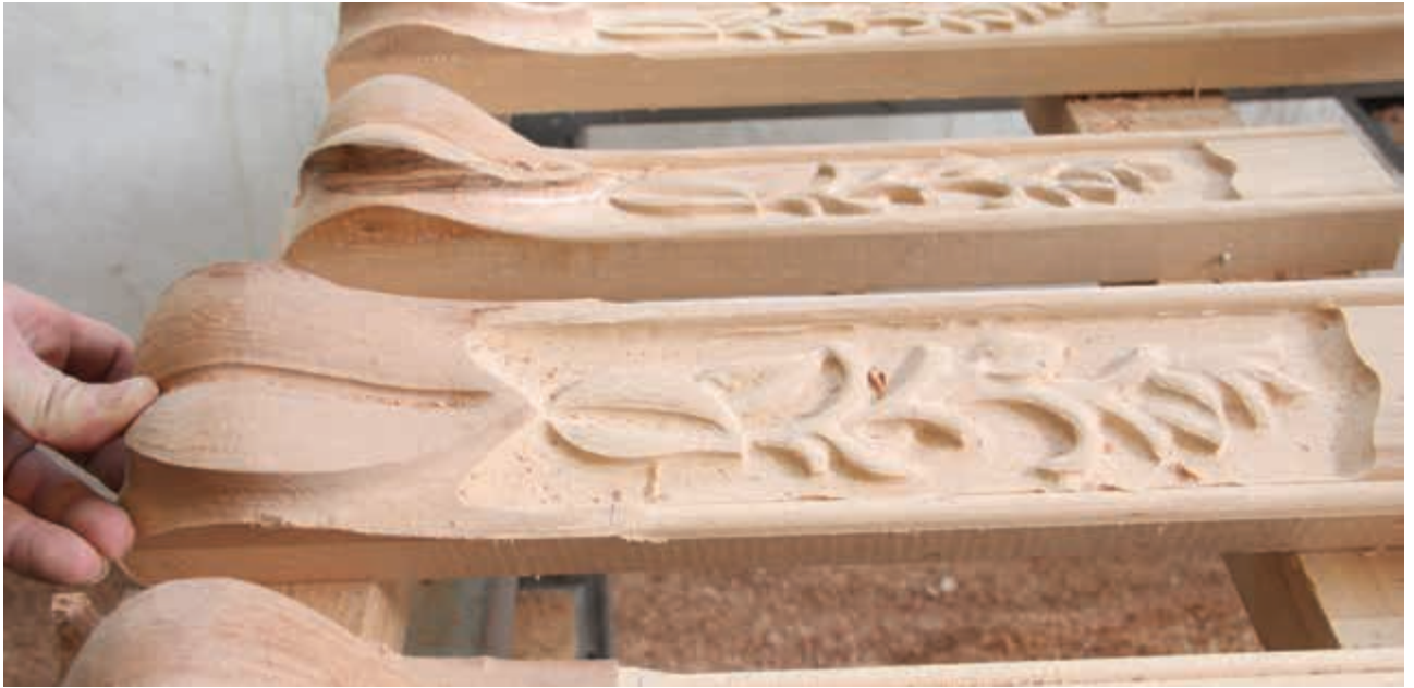
الشكل (٢-٢٧): حفر منفذ بآلة الحفر الناسخة.
