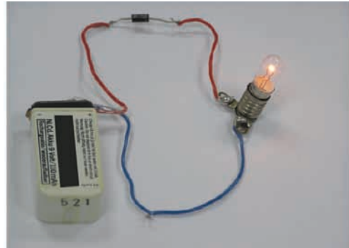
الشكل (٣): اختبار عملي لانحياز الثنائي شبه الموصل
