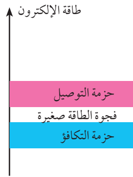
الشكل (٤): أحزمة الطاقة في المادة شبه الموصلة
