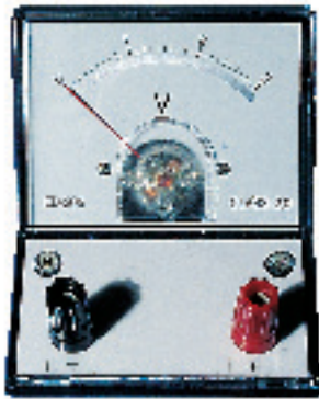
شكل 2 - 12 يقيس الفولتيمتر القوة الدافعة الكهربائية أو فرق الجهد
