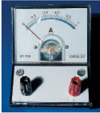
شكل 2 - 2 يقيس الأميتر شدة التيار الكهربائي
