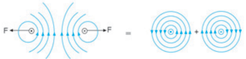
شكل 6-7 أ) توحيد مجالات مغناطيسية نتيجة تيارات في اتجاهات معاكسة
