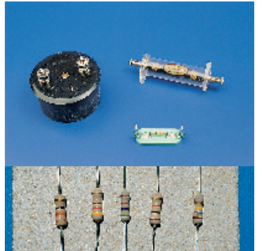
شكل 2-13 الأنواع المختلفة للمقاومات الثابتة
