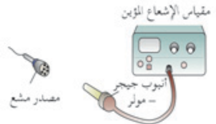
شكل 9-9 الكشف عن النشاط الإشعاعي بواسطة أنبوب جيجر - مولر المتصل بمقياس الإشعاع المؤين
